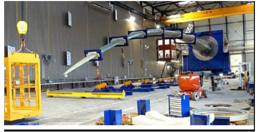
Pale d'éolienne de grande envergure 100 m réalisée en matériaux composites
